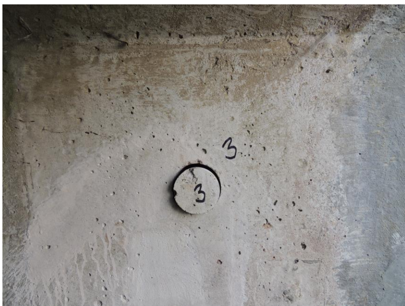
Místo odběru vzorku číslo 3 pro stanovení pevnosti betonu prefabrikátu
