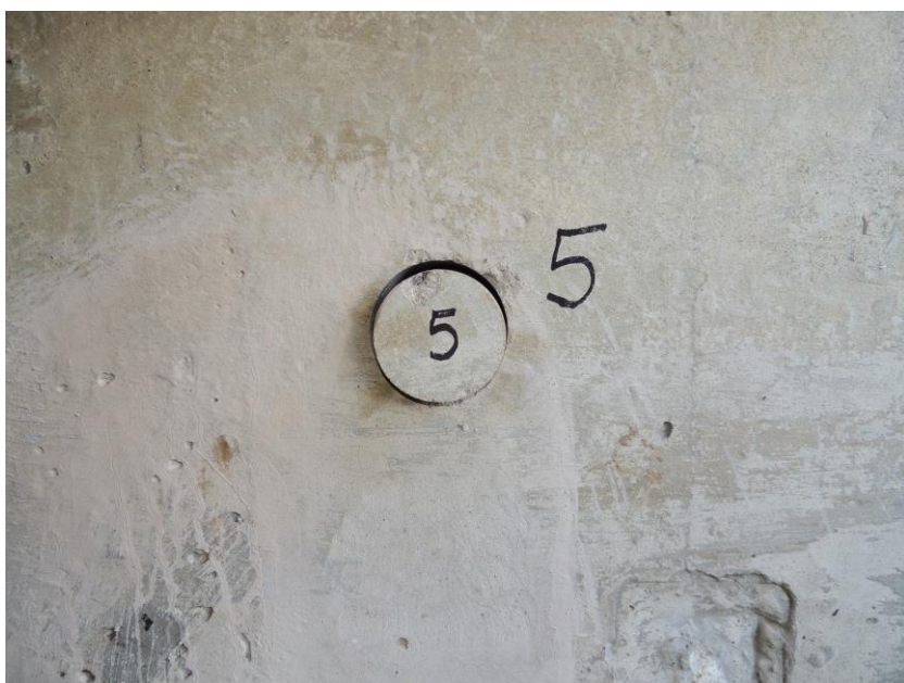
Místo odběru vzorku číslo 5 pro stanovení pevnosti betonu prefabrikátu
