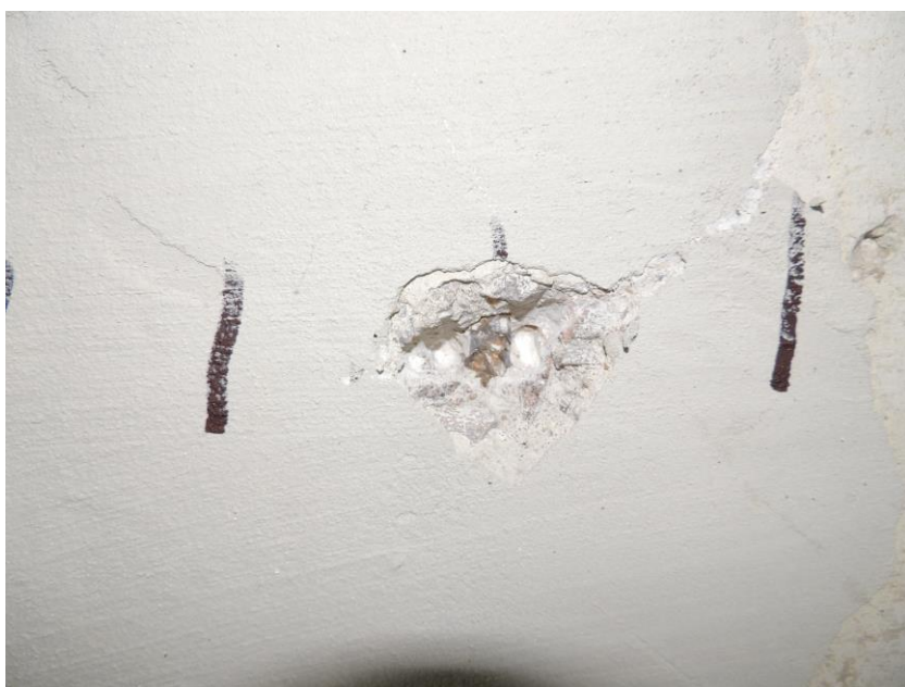
Sonda pro ověření pohledových charakteristik a průměru výztuže
